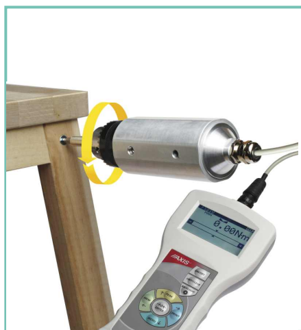
Pomiar "siły" potrzebnej do odkręcenia wkręta
