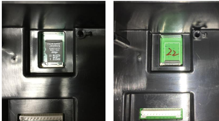
Figure 2-5 couissant une carte SD dans la fiche SD (gauche); carte SD installée (droite).
