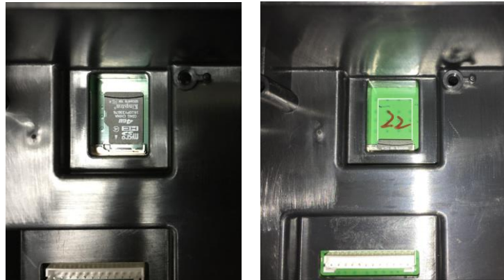
Abbildung 2-5 Einschieben einer SD-Karte in die SD-Buchse (links); SD-Karte installiert (rechts)
