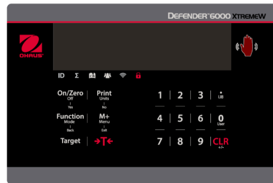
Pannello di controllo i-DT61XWE
